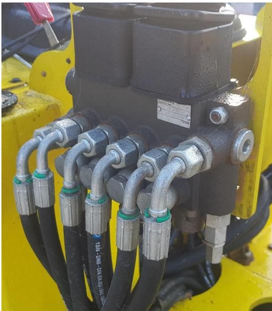
Attention, avant de démonter le manomètre, reposer tous les éléments au sol, couper le moteur thermique et faites bouger les commandes dans tous les sens pour retirer la pression.
