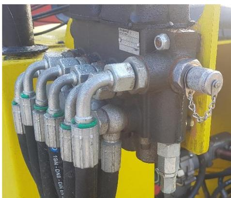
Monter le raccord male ½ sur le distributeur.
