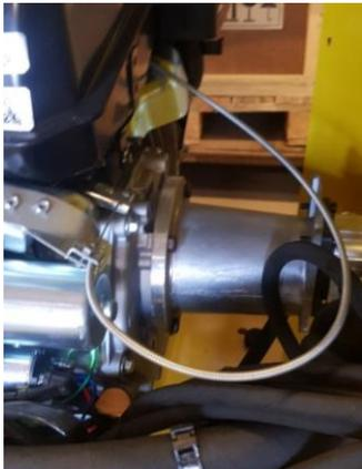
Faire passer le câble dans le guide en faisant une boucle suffisamment large pour que le câble ne force pas à l'usage.
