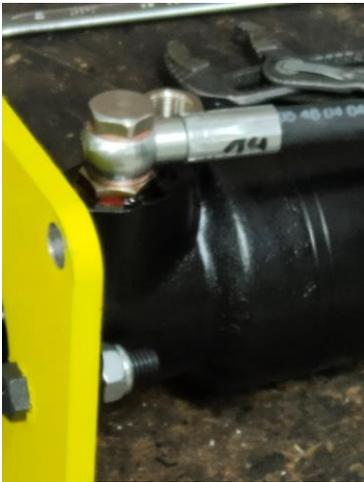
Monter les flexibles sur le moteur hydraulique jusqu'au distributeur.
