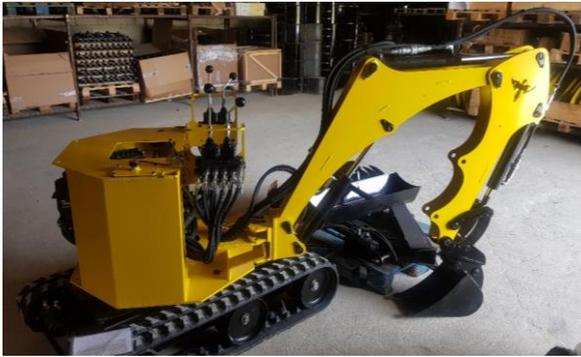
Vérifier au niveau des articulation de chaque bras que les flexibles aient assez de jeu pour ne pas être endommagés lors de l'utilisation de la machine.
