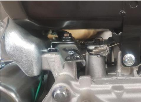
Desserrer l'écrou de bridage de l'accélérateur jusqu'à ce que la tirette bouge sans résistance.
