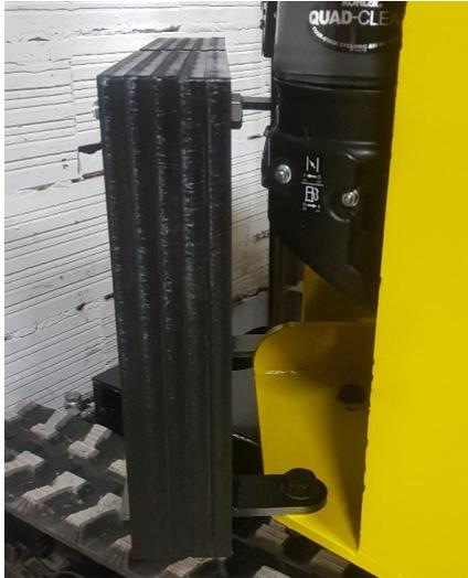
Monter la première plaque contre poids avec l'axe pivot, verrouiller celui-ci avec une vis 6x16 sur le haut de la tourelle.
