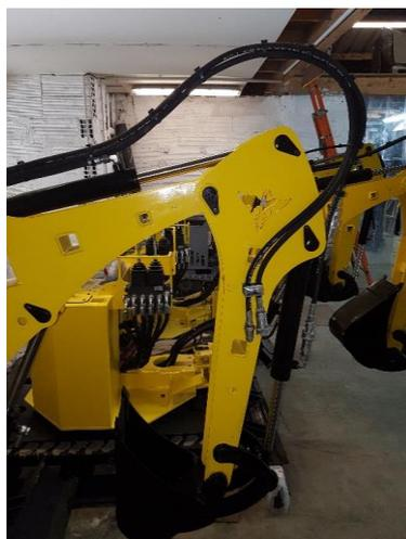
Ligne hydraulique supplémentaire en bout de flèche, ce sont 2 flexibles tirés depuis le distributeur gauche, remplaçant le bypass des flexibles 15-16 jusqu'au bras de balancier.
