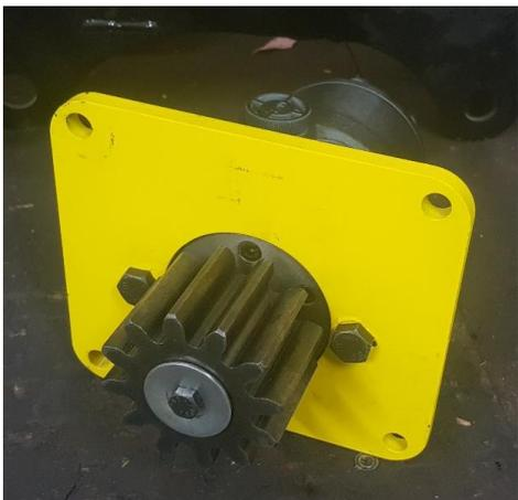
Monter le pignon sur le moteur hydraulique puis le verrouiller avec une vis de 8x50 + rondelle large.
