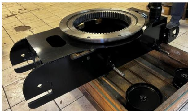
Mettre en place les axes des rollers, 4 axes  $\varnothing 25$  lg 175 avec goutte d'eau
