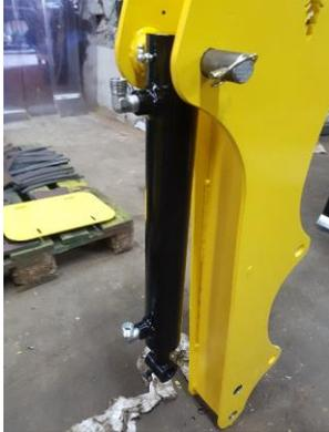
Monter le bras de balancier et un vérin de 30/50 c 300 au bout du bras.
