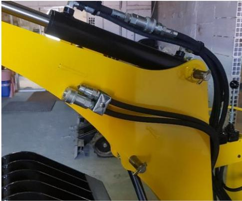
Monter la ligne auxiliaire depuis le distributeur arrière et la fixer sur le bras de levée en attente pour l'alimentation d'un outil auxiliaire.
