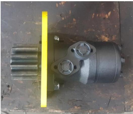
Monter le moteur hydraulique sur la plaque de rotation tourelle, attention au sens de montage du moteur, la plaque est réversible pour pouvoir être utilisée avec la couronne pro ainsi que la couronne standard.
