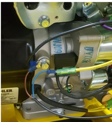
Brancher le câble au moteur Kohler, le câble marron à la masse et le câble bleu sur un des câble jaune (+ après contact) du moteur.
