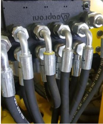
La ligne 15-16 n'est pas utilisée de série, celle-ci est obstruée avec un petite flexible en bypass.
