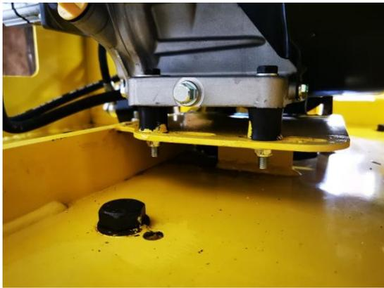
Positionner le moteur thermique sur les silentblocs puis visser le avec des vis de  $8 \times 35$  + rondelle  $8 \times 30$  coté trou oblong et M8 sur les perçages classiques.
