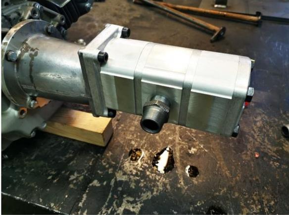
Monter le raccord union basse pression  $\frac{1}{4}$  sur la pompe.
