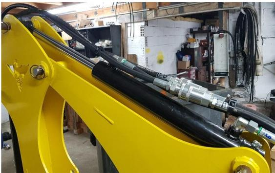
Visser les Raccords rapide sur les flexibles 11 et 12 avec du ruban téflon et bien les verrouiller.
