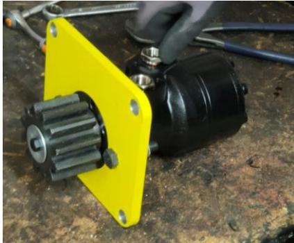
Monter les réductions (avec téflon liquide ou ruban).
