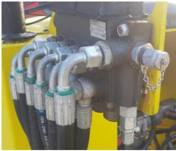
Monter le raccord male 1/4 sur le distributeur.
