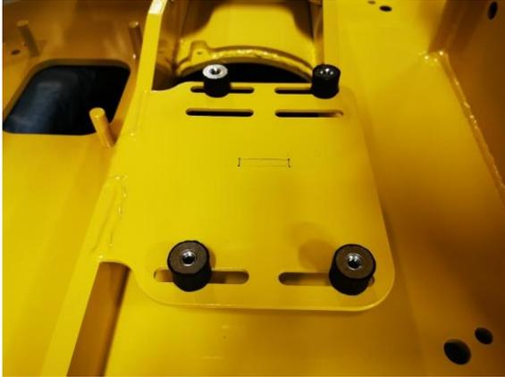
Monter les 4 silentbloc avec 1 rondelle  $\varnothing 8 \times 30$  + écrou frein M8 sur le châssis moteur sans les verrouiller pour le moment
