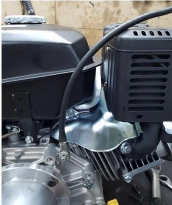
Brancher le fil de masse sur une des vis du carter du moteur.
