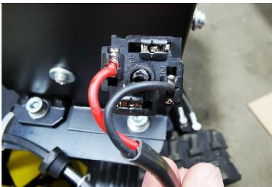
Démonter la protection sur le côté du radiateur puis brancher le câble d'alimentation.
