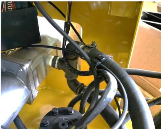
Connecter les flexibles d'alimentation du réservoir aux pompes
