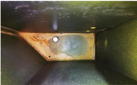
Monter 1 boulon 18x50 avec rondelle normal et une cuivre et ruban téflon dans le fond du réservoir, verrouiller fortement le boulon pour éviter les fuites.
